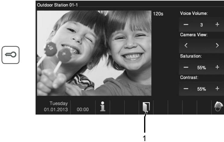
Fig. 11 Opening the door
